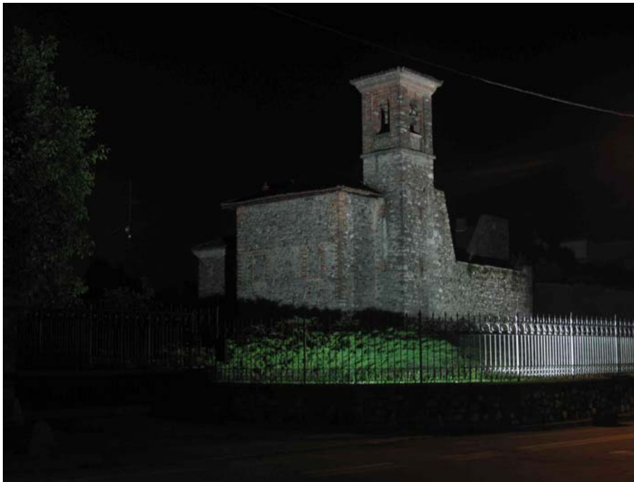
Chiesa di S. Rocco: percezione fotografica diurna e notturna. L'illuminazione d'accento della Chiesa di S. Rocco è realizzata con proiettori di proprietà privata, installati a terra ed equipaggiati con lampade ad alogenuri metallici con bruciatore ceramico.
